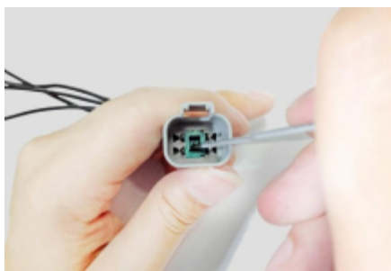
1.用取卸工具末端的小倒钩钩住压板。 Hook the inside wedge by small end edge of extraction tool .
