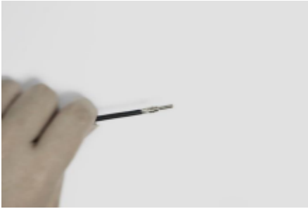
1. 将芯线铆压好端子。 Crimp contact .
