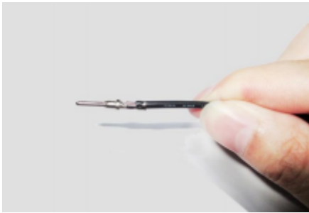
1.将芯线铆压好端子。 Crimp contact .
