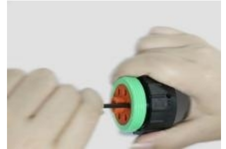
3. 推动端子垂直插入连接器内，感觉到不能向前推进时，可以轻微地向后拉，确定端子已被锁紧。
